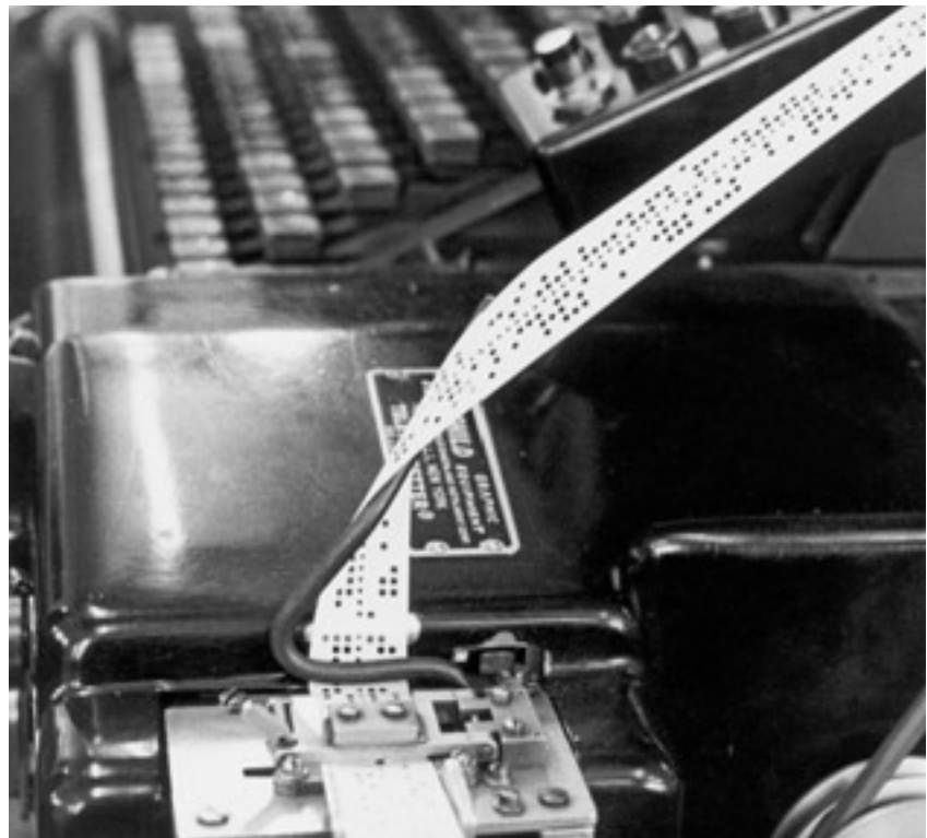
Setzen mit Lochstreifen (Foto «Ostschweiz»)
